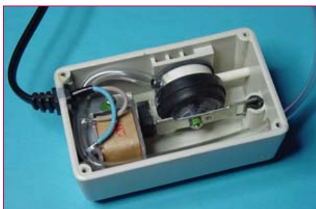
Bild 9. Die Pumpe mit montiertem Ansaugstutzen.
