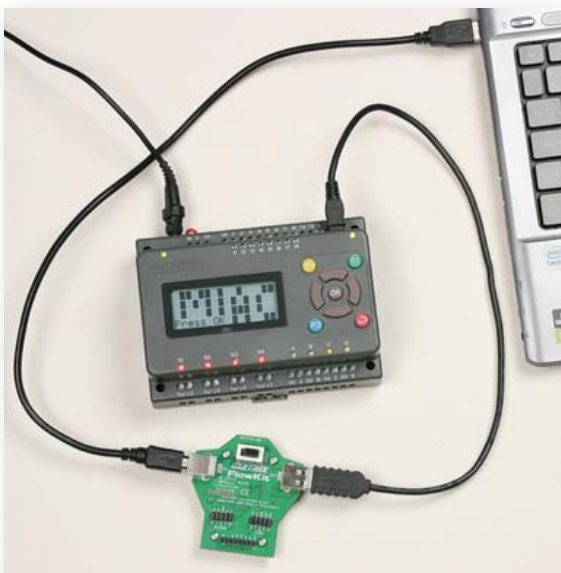
MIAC ermöglicht mit dem optional erhältlichen FlowKit-Modul (Art.-Nr. HP299) volles In-Circuit-Debugging in Flowcode
