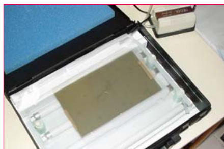
Bild 10. Die Belichtung kann nun mit Unterdruck stattfinden.
