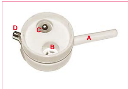
Bild 7. Der modifizierte Pumpenkörper von der Membranseite aus gesehen: Druckanschluss (A), Druckventil (B), Saugventil (C) und Sauganschluss (D).
