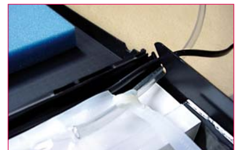
Bild 11. Hier wird der Schlauch für die Luftabsaugung durchgeföhrt.
